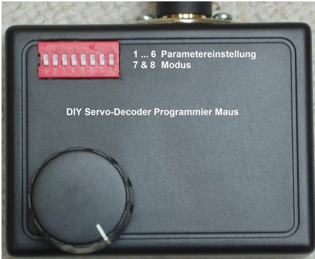
Dieses Selbstbau-Projekt ermöglicht über den SX-Bus das Einstellen von Servos direkt am Einbauort, die mittels Servodecoder-Bausatz SD-8 angesteuert werden.
